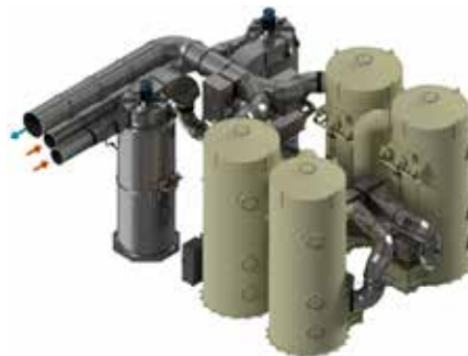
Natfilters + na-geschakelde Gaswassers 80.000 m 3 /u
